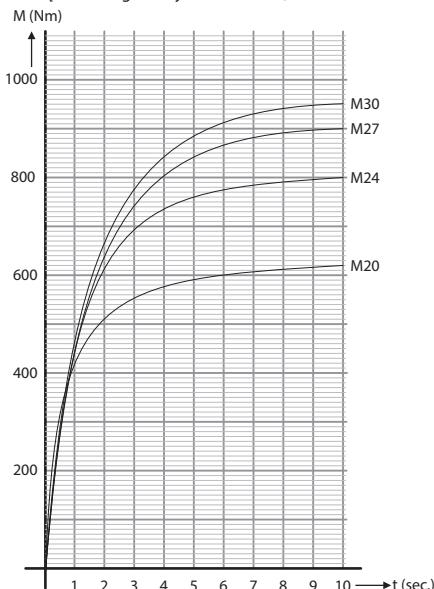
W zależności od typu i charakteru dokręcanych części każdy przypadek należy wyprosić osobno. Czas dokręcania dłuższy niż 10 s ma znakomity wpływ na zwiększenie momentu dokręcania.
