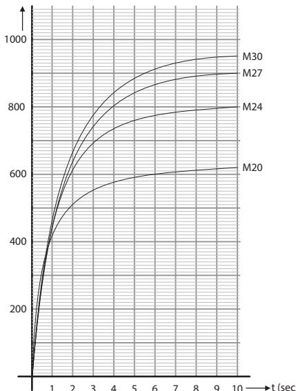
A meghúzott alkatrészek fajtája és jellege szerint minden eset külön próbát igényel. A 10 másodpercnél hosszabb meghúzási idő csak jelentéktelenül növeli a meghúzási nyomatékot.
