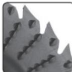
A horonymaráshoz és a daraboló-vágó munkákhöz használható fűrészfogakon (mindkét oldalon) ráspolyfogak találhatók. A fogárkokból sugárirányban további ráspolyfogak állnak ki a tárcsából (lásd a képet). A ráspolyfogak egryrészt szélesítik a hornyot (vágási részt) a fűrészfogak akadálymentes előre haladásához, másrészt a tárcsa dőlésszögének a megváltoztatása esetén lemunkálják a tárcsa által érintett felületről az anyagot, így a tárcsa nem szorul be a vágási résbe (horonyba).
